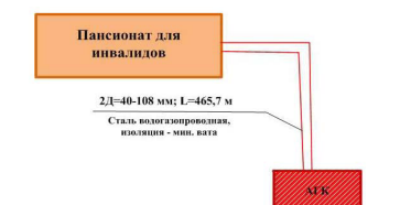
Рис. №13 – Схемы тепловых сетей АГК пансионата с. Бахилово
